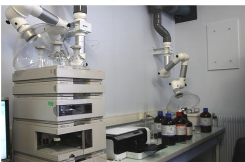
Dispositif à chromatographie sous phase liquide
