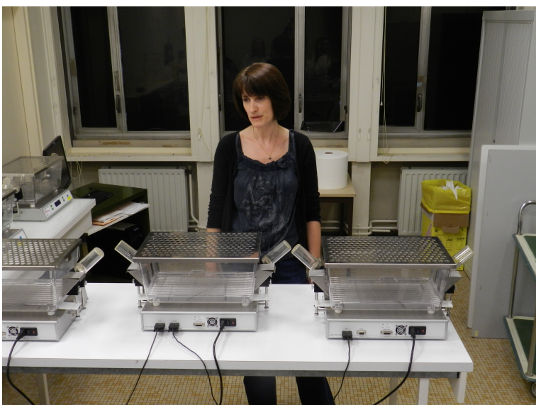
Ces cages sont composées de balances reliées à un ordinateur, elles permettent de savoir les préférences alimentaires, la quantité de nourriture et le moment où mange le rat.
